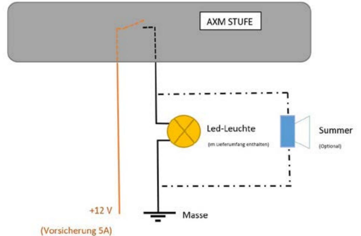
Montagematerial für die elektrische Verdrahtung ist bei der AXM Stufe nicht im Lieferumfang inbegriffen und muß vor Ort durch eine fachkundige Werkstatt durchgeführt werden.
