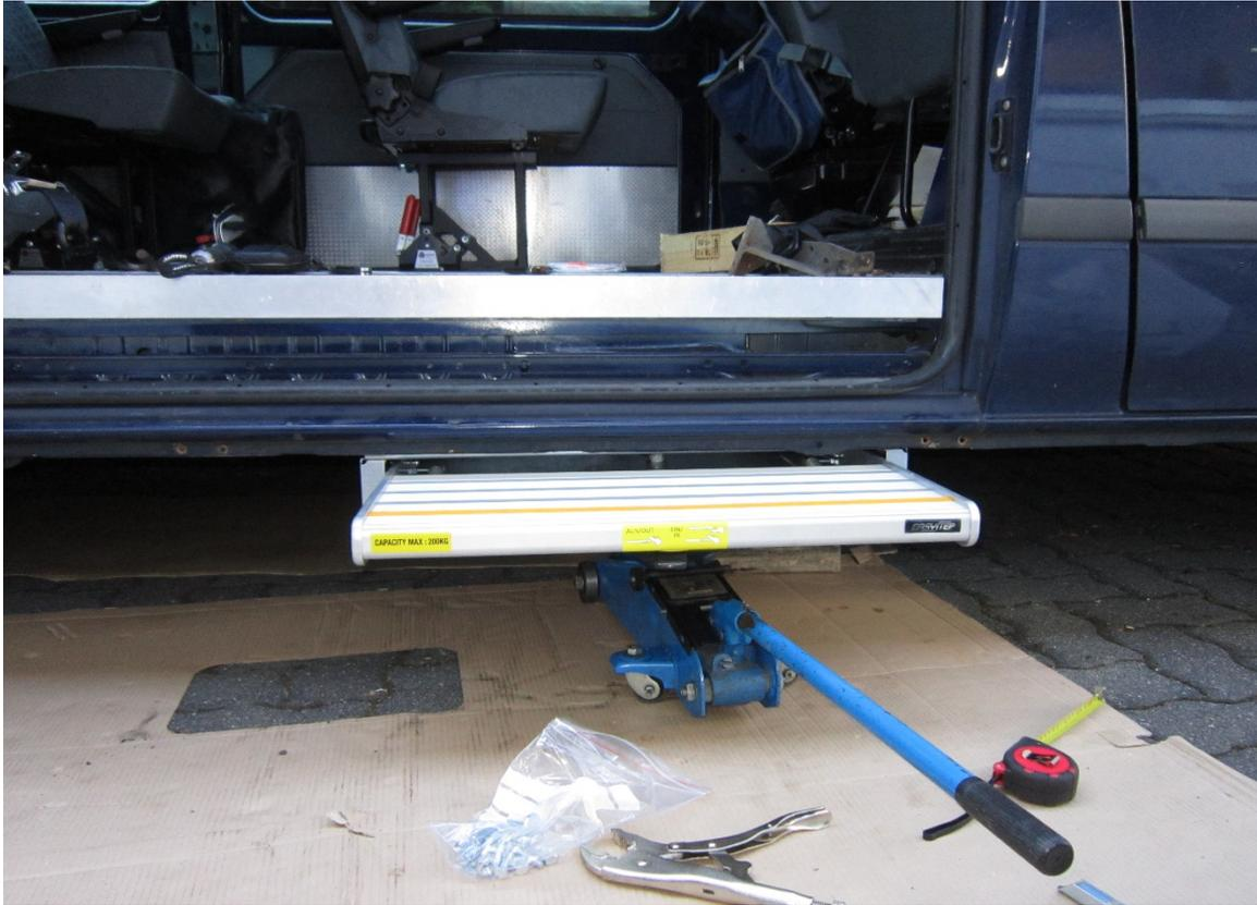
1. Mit einer Hebevorrichtung oder Holzklötzen bringen Sie die Trittstufe in die gewünschte Position unterhalb der Schiebetür.
