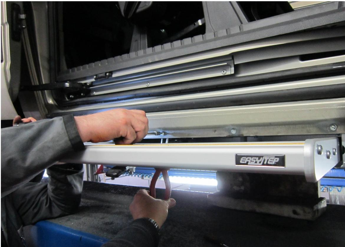
4. TIR-Trittstufe ausfahren lassen, mit Hebeeinrichtung wieder in Position hinter den Schwellersaum bringen. Wenn der Schwellersaum an dr Rückseite uneben ist müssen M10er Muttern oder Unterlegscheiben zwischengepackt werden.
