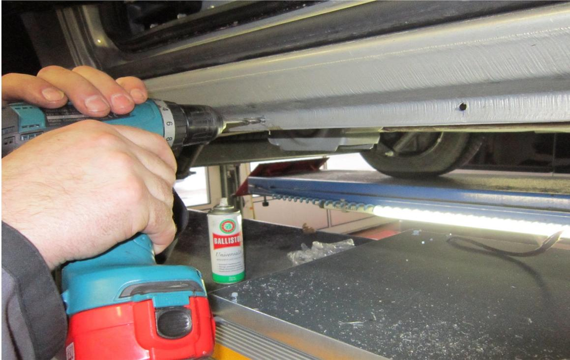
3. Trittstufe noch einmal absenken und Schraubenlöcher  $\varnothing$  6,5mm in den Schwellersaum bohren. Achtung: Bohrlöcher mit Rostschutz behandeln und trocknen lassen.
