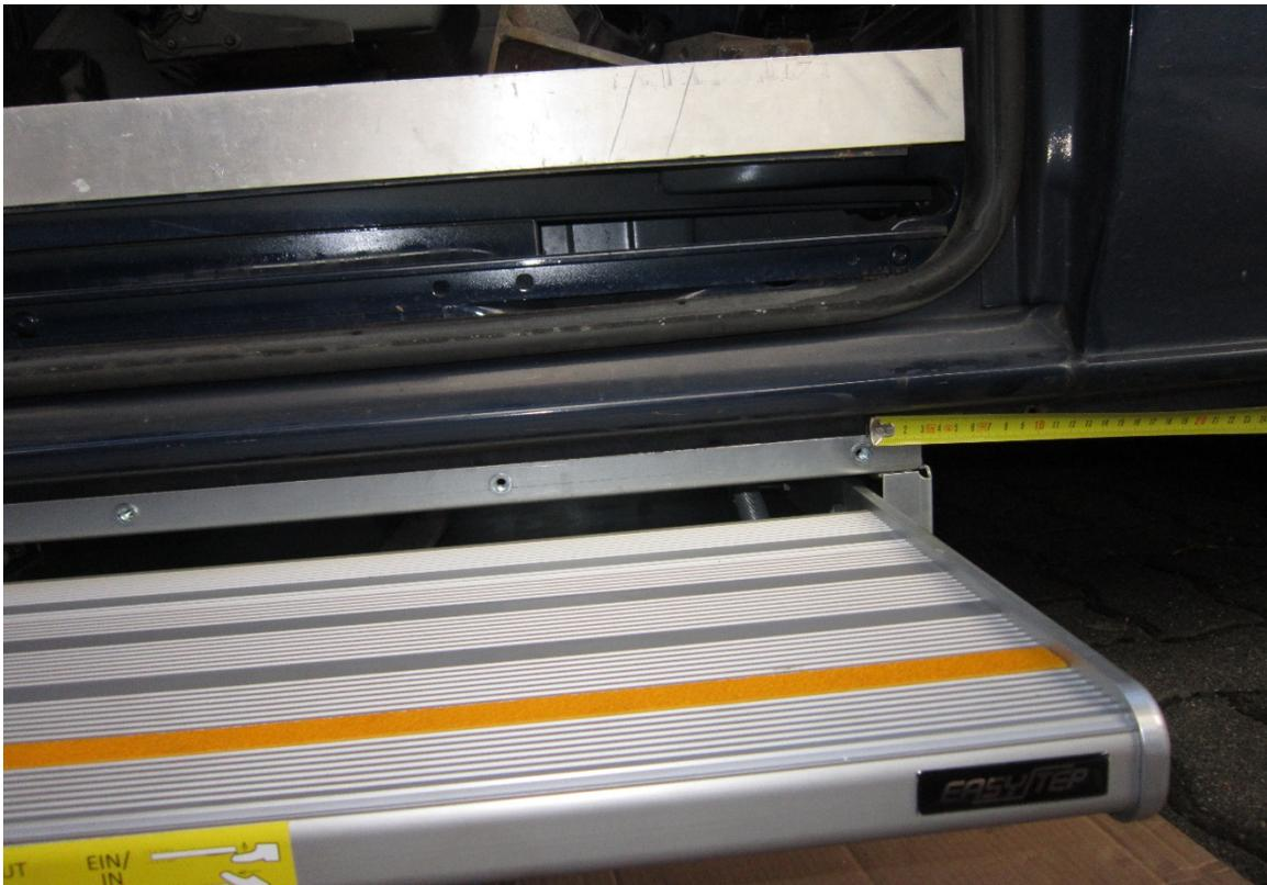
2. Dann heben Sie die Befestigungslasche der TIR vor den Schwellersaum so hoch wie es die Trittstufe zulässt und zeichnen durch die Gewindemuttern hindurch die Bohrlöcher auf dem Schwellersaum an.
