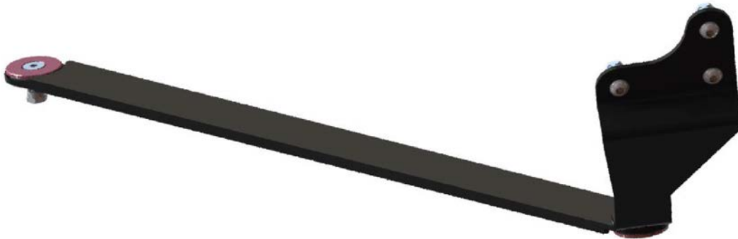
ABBILDUNG 3: TÜRBEFESTIGUNGSSATZ SPRINTER 2018 FRONTANTRIEB (WI-00109)
