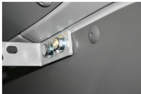
Abb. Winkelbefestigung – Seitenwand und Fahrzeugholm
