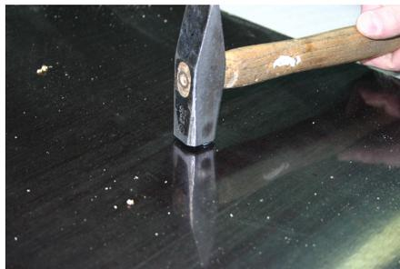
Abb. Einschlagmutter – Rückseitig Bodenplatte
