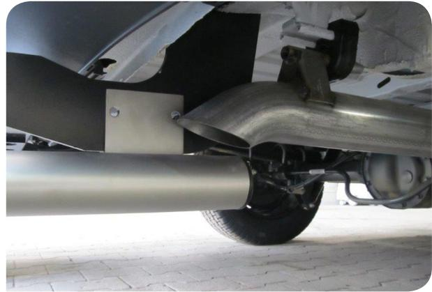
Wenn neuerdings links keine Bohrungen vorgefertigt sind, ist die Stufe erst rechts zu montieren, dann in Waage und parallel zum Fahrzeug auszurichten. Links die Bohrlöcher anzeichnen und danach auf 10,5 mm bzw. 12,5 mm aufbohren. Bohrlöcher gegen Rost schützen.
