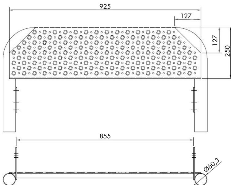
Die HE-Hecktrittstufe wird in einem Teil ohne Montage-Set geliefert, weil die Montagepunkte bereits mit Schrauben versehen sind.
