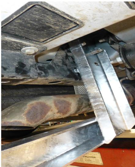
Das Auspuff-Endrohr wird, wenn es stört, bis auf 5 cm nach der letzten Aufhängung gekürzt und mit der Schelle und dem neuen Endstück vervollständigt.
