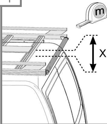
**F/** Si la garde au toit **X<55 mm** : démonter la galerie du véhicule.
