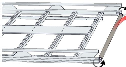
**F/** Si un rouleau est installé sur la galerie d'origine, dévisser les extrémités et le démonter.
