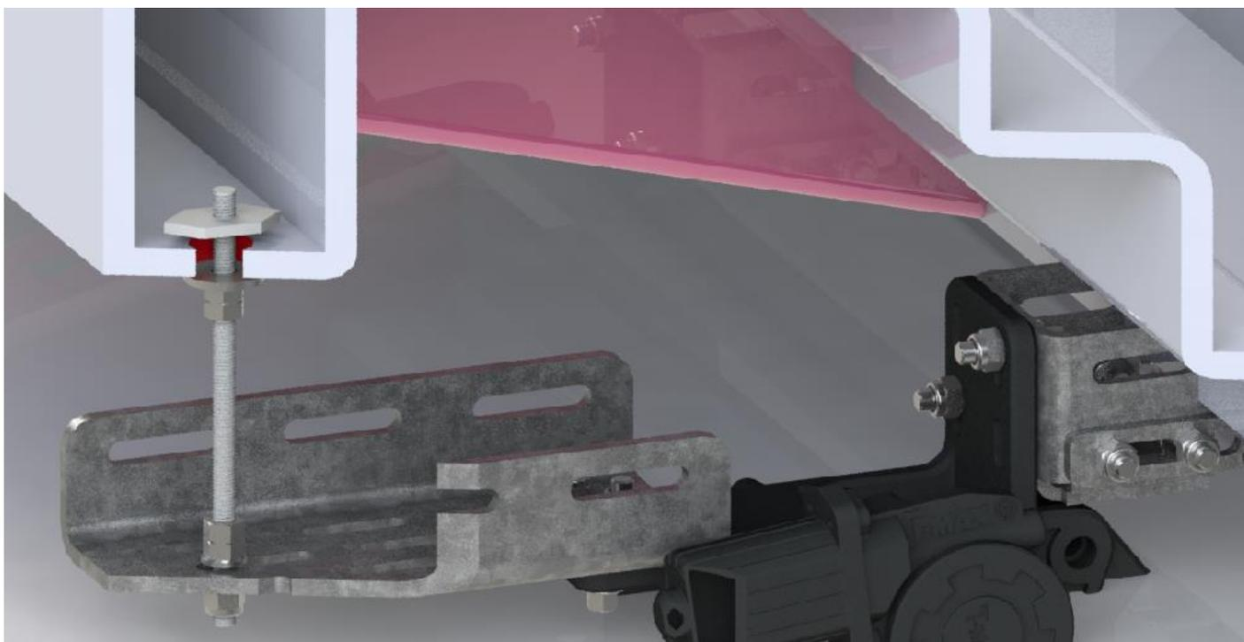
Abbildung 12: Schematische Darstellung - Befestigung hinterer Halter 1
