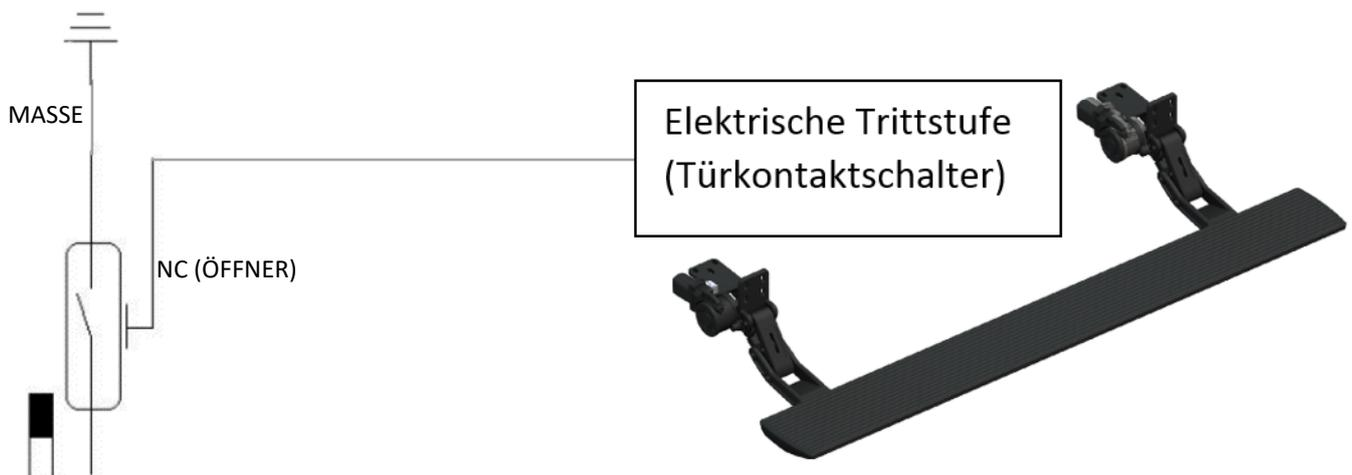
Abbildung 20: Anschluss Türkontaktschalter
