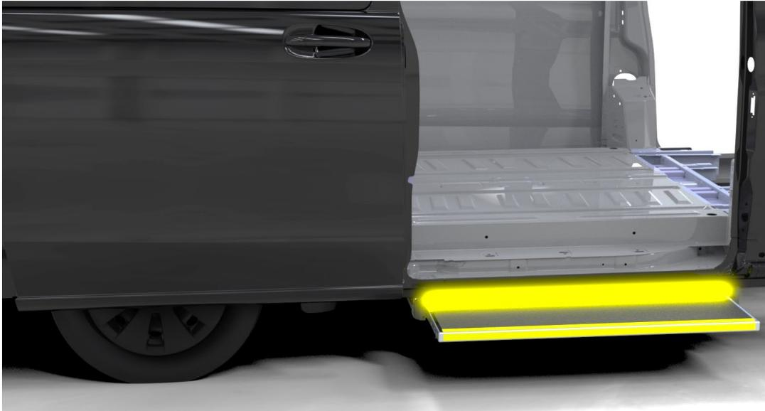
Die Halter werden positioniert und mithilfe der Kippdübel am Fahrzeugträger verschraubt.
