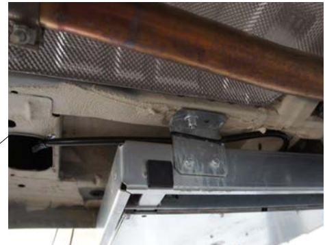
Kabel in der B-Säule hochbringen
