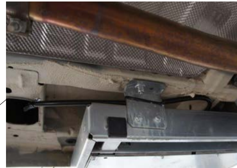
Kabel in der B-Säule hochbringen
