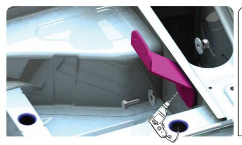
Anschließend kann der Halter mit dem Fahrzeug verschraubt werden.
