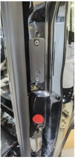
Wenn die original elektrische E-Leiste nicht voll belegt ist, kann dort an der Schiebetür und an der B-Säule der Magnet-Sensor leicht montiert werden. Vorteil: es wird nicht im Metall gebohrt.
