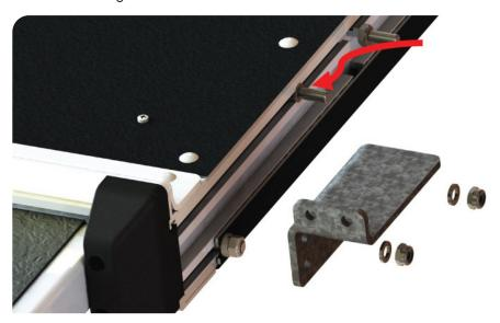
Beide Sechskantschrauben dafür in das Aluprofil führen und damit den vorderen Halter befestigen. Muttern noch nicht anziehen!
