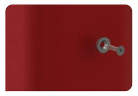
Der Magnet kann mithilfe der Blechschraube an der Tür befestigt werden. Nur von Hand montieren, da bei maschinellem Einschrauben zu viel Druck auf den Magnet ausgeübt wird und dieser zerbricht. Alternativ kann dieser auch mit geeigneten Mitteln aufgeklebt werden.
