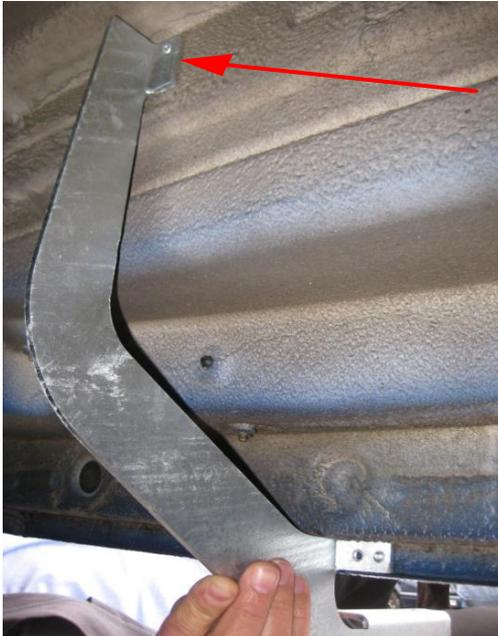
Bei BM907 = ab 2018, wird hier ein Distanzstück 20mm zwischen Blech und Halter gelegt.
