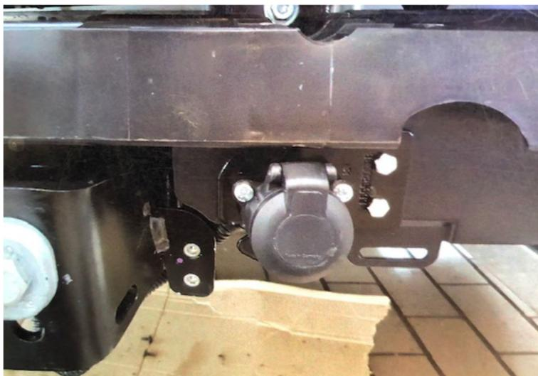
Vor der Montage muss die Steckdose möglichst hoch versetzt werden und mit geeignet mitteln neu befestigt werden.
