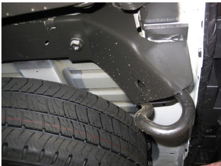
Vor der Montage des linken Halters die Abschleppöse entfernen.
