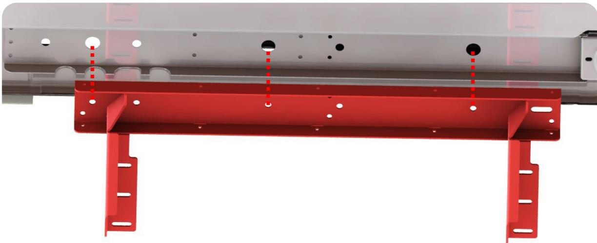
Den Halter an den Bohrungen ausrichten und die Stellen markieren, an denen folgende Bohrungen an der Karosserie vorgenommen werden müssen.
