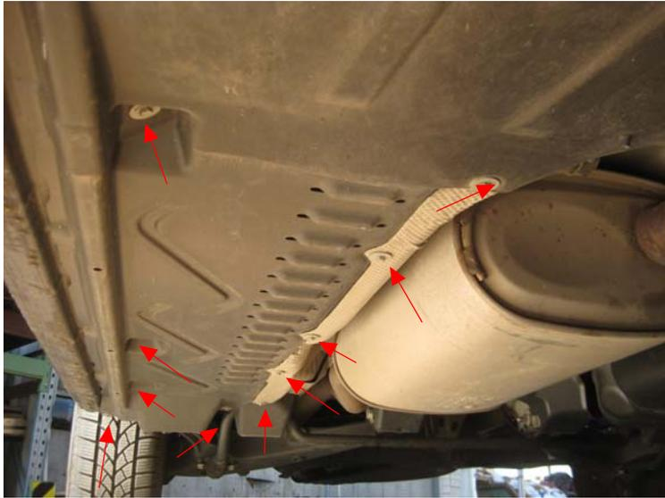
Die 10 Schrauben lösen und Unterbodenverkleidung abnehmen.
