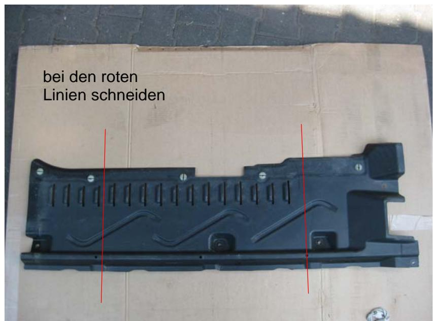
Nach Abschluss der Montage muss die Verkleidung aufgeschnitten werden und das Mittelstück wird entsorgt.
